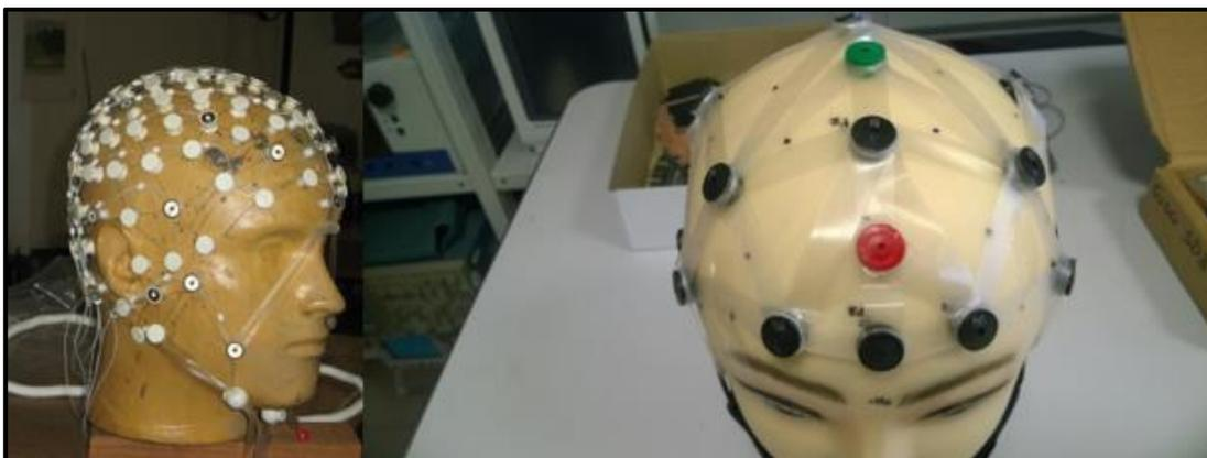
**Fig. 4:** A sinistra una cuffia di vecchia generazione; a destra una di ultima generazione.
