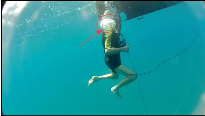
**Fig. 2:** Implosione della guarnizione del casco Passor.
